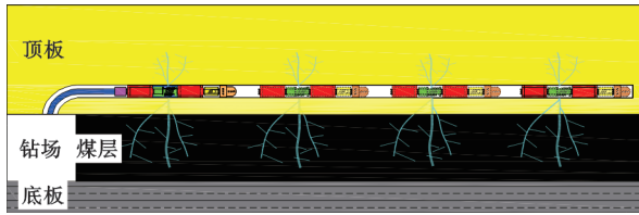
图 11 煤层顶板定向长钻孔分段压裂
