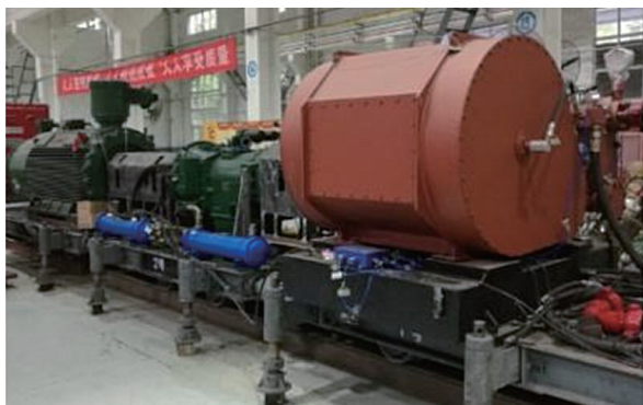
图 9 低压端加砂压裂泵组
